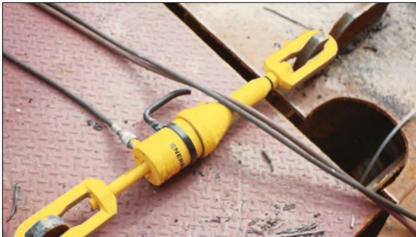
▼ Para posicionar um mastro estrutural, os cilindros BRP foram usados para tensionar os cabos de estaiamento.
